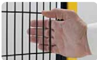
La dimension de l'ouverture **e** correspond au côté d'une ouverture carrée, au diamètre d'une ouverture circulaire et à la plus petite dimension d'une ouverture en fente.
